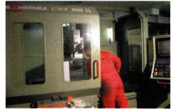
Auch planen z.B. das Planen der Köpfe wird auf der Fräsmaschine bearbeitet
