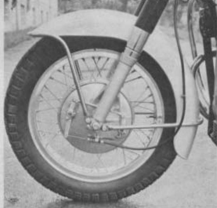
A SINISTRA: Le borsette laterali si aprono verso il basso dopo aver svitato il solito pomello e presentano una discreta capacità. A DESTRA: Il poderoso freno anteriore a doppia camma.
