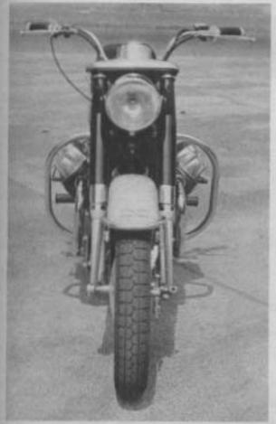
La vista frontale à caratterizzata dalla sporgenza dei due cilindri, che risultano così ottimamento esposti al vento della corsa. Rispetto al complesso dell'avantreno (si osservi il supportoparaurti del parafango) il faro risulta un po' piccolo.
