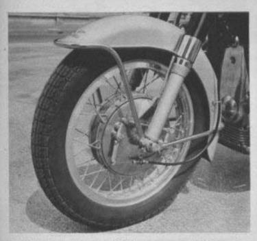
La ruota anteriore con il cerchio in lega leggera ed il grosso tamburo del freno a doppia camma e ganasce flottanti. Il perno del mozzo è sfilabile. Oltre al registro per il cavo del freno, si osservino anche qui i sopporti cromati del parafango.
