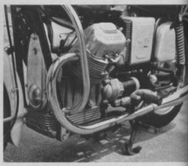
Il blocco motore visto di tre quarti da sinistra. I cilindri sono ottimamente protetti dai tubi paracolpi. Le candele sono bene esposte al vento della corsa. Sulla parte frontale, il carterino della cinghietta per la dinamo e, sopra, il clacson.
