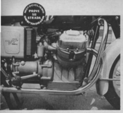
Il blocco motore-cambio visto da destra, di linea prettamente automobilistica. Sulla parte superiore della scatola del cambio è visibile il tappo per il rifornimento olio. Seminascoste dalla leva ant. del pedale del cambio si intravvede il tappo di controllo livello.
