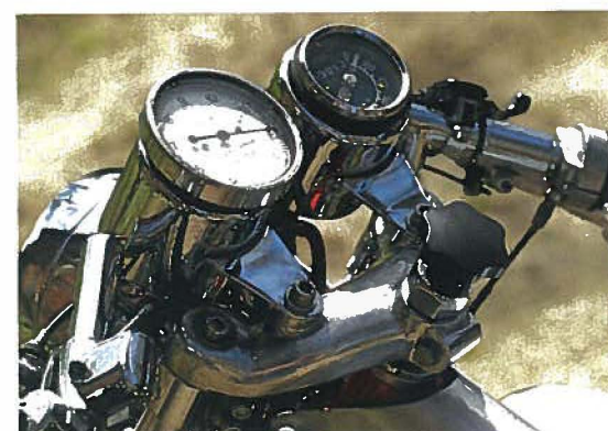
Muss ja: Die quirlige Motobi braucht einen Drehzahlmesser. Dieser wurde nachgerüstet
