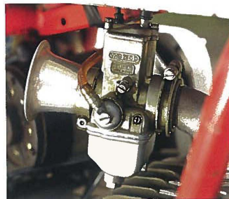
Tuning? Eigentlich trägt der 29er-VHB-Dellorto keinen offenen Trichter
