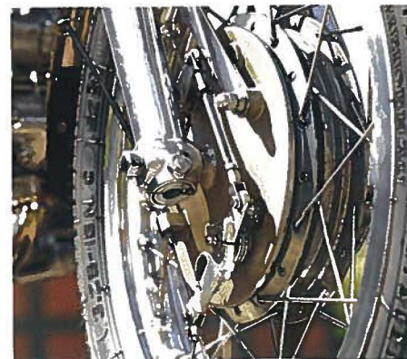
Schöner als Scheiben: die fein dosierbare Doppelnockenbremse vorn
