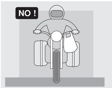
Ne jamais fixer d'objets encombrants, volumineux, lourds et/ou dangereux sur le guidon, les garde-boue et les fourches : cela pourrait ralentir la réponse du véhicule en virage et compromettre inévitablement sa maniabilité.
