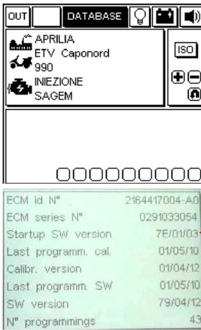
Lorsque la communication entre AXONE2000 et le boîtier électronique commence, l'icône animée devient une ampoule qui clignote.
