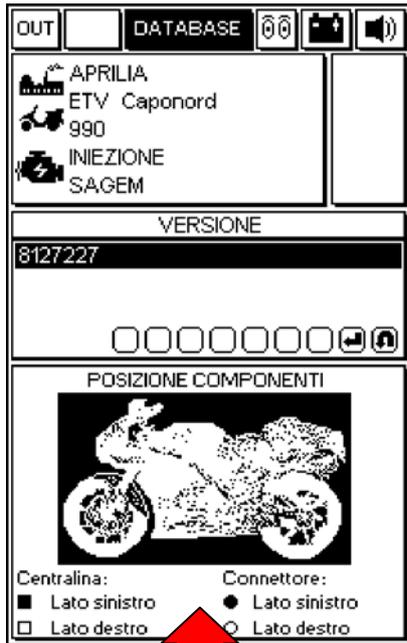
POSITION DU BOITIER ELECTRONIQUE (ECU) ET DU CONTACT DIAGNOSTIC
