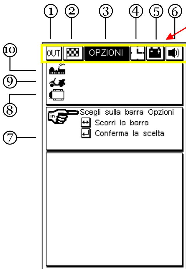
Pour sélectionner les icônes sur la partie supérieure de l'écran, utiliser les touches flèche ← →.
