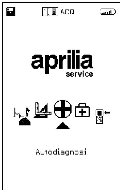
**Le triangle noir met en évidence la fonction sélectionnée : se placer sur AUTODIAGNOSTIC et appuyer sur la touche entrée.**
